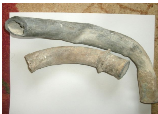
FIGURA 1. ȚEVI DE PLUMB PENTRU APA RECE FOLOSITE ÎNAINTE DE 1989 ÎN ROMÂNIA.
