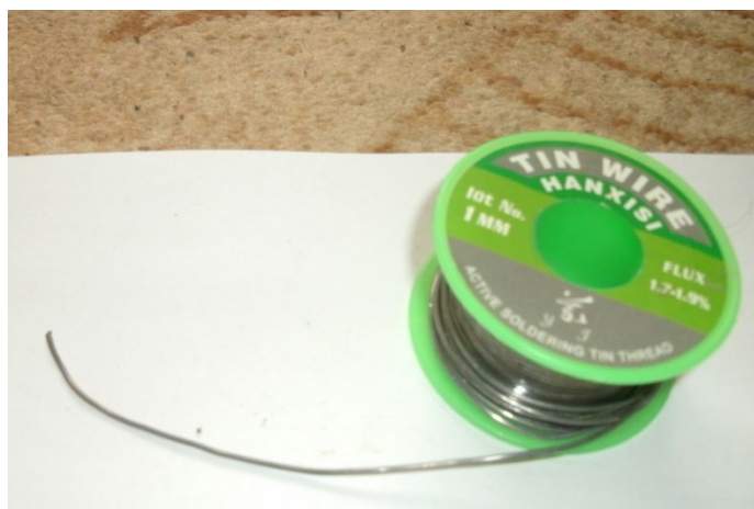
FIGURA 2. SÂRMĂ DE STANIU FOLOSITĂ PENTRU LIPIREA COMPONENTELOR ELECTRONICE PE PLACA DE CIRCUITE IMPRIMATE.
